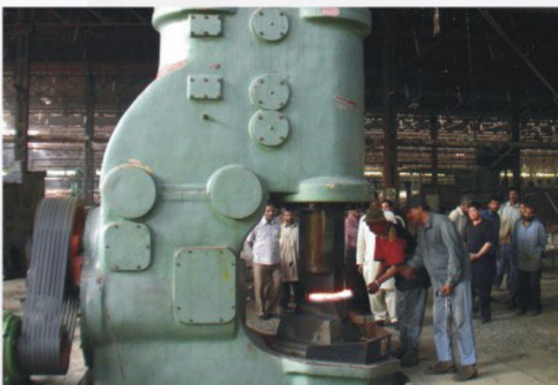
C41-1000空气锤在巴基斯坦使用 C41-1000 Pneumatic Hammer in Pakistan
