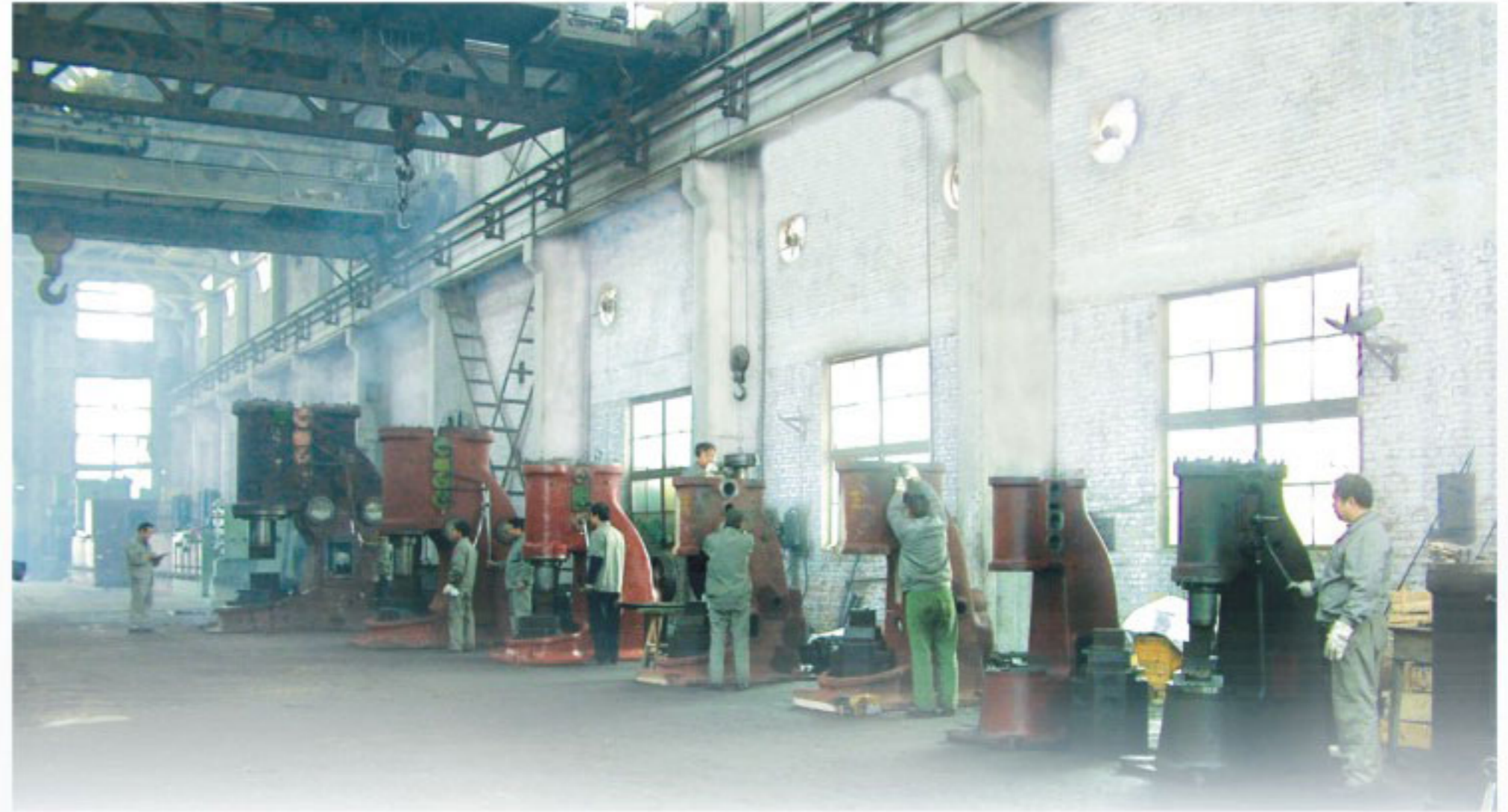
空气锤装配车间 Assembly workshop
