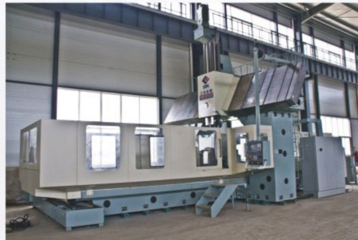
数控加工中心 CNC Maching center
